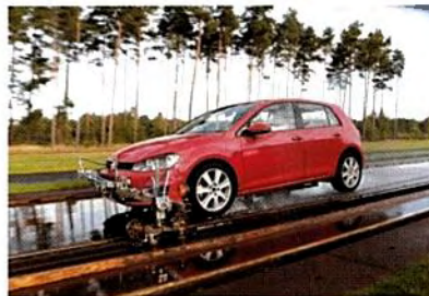
Däcken testas bland annat på asfalterad raksträcka med 7 millimeter djupt vatten.
