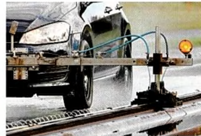
På bilen fästs flera datorer. De mäter de olika krafterna som är i rörelse vid vattenplaning.
