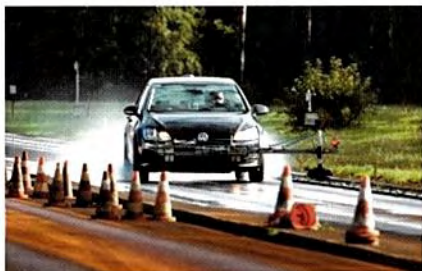
Däcken testas bland annat på asfalterad raksträcka med 7 millimeter djupt vatten.
